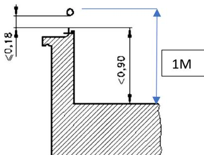
*Si hauteur de l'allège < 90 cm alors installer un garde-corps à 1 mètre du sol, en faisant attention que l'espacement entre le rebord de fenêtre et le garde-corps n'est pas supérieur à 18 cm.*
